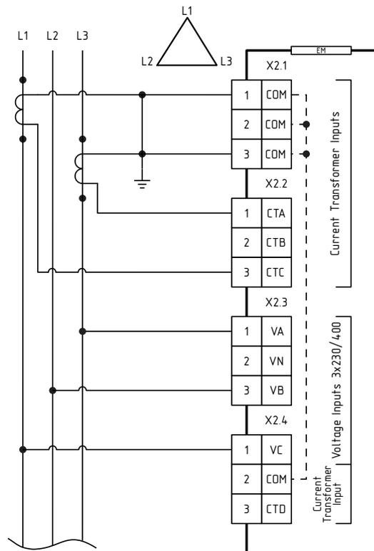
Рисунок А.7 – Трёхфазное трёхпроводное соединение 3L2, использующее 2 трансформатора тока
