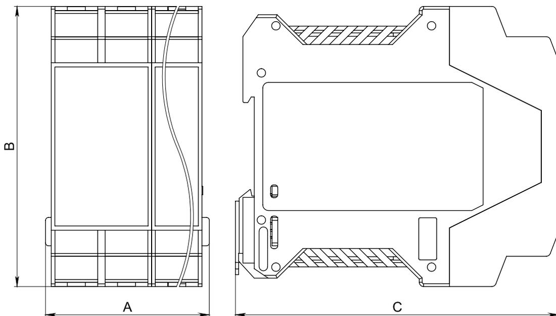
Рисунок 1.6 – Габаритные размеры EM-12-AMW(DMW), EM-12-ARW(DRW), EM-12-ACW(DCW)
