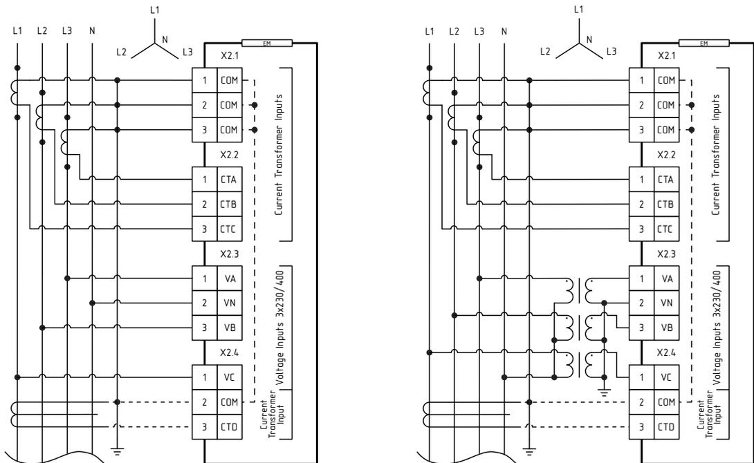
Рисунок А.2 – Трёхфазное четырёхпроводное соединение 4LN3
