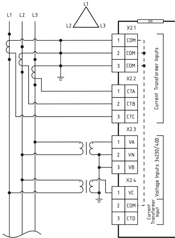
Рисунок А.8 – Трёхфазное трёхпроводное соединение ЗОРЗ, использующее 2 трансформатора напряжения
