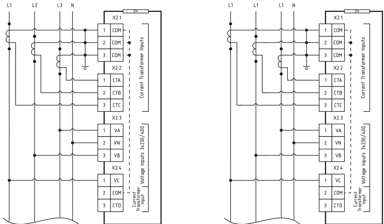
Рисунок А.11 – Примеры независимого контроля трех линий
