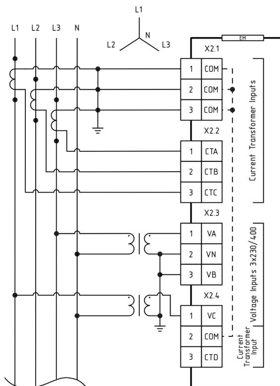
Рисунок А.4 – Трёхфазное четырёхпроводное соединение 3LN3, использующее 2 трансформатора напряжения
