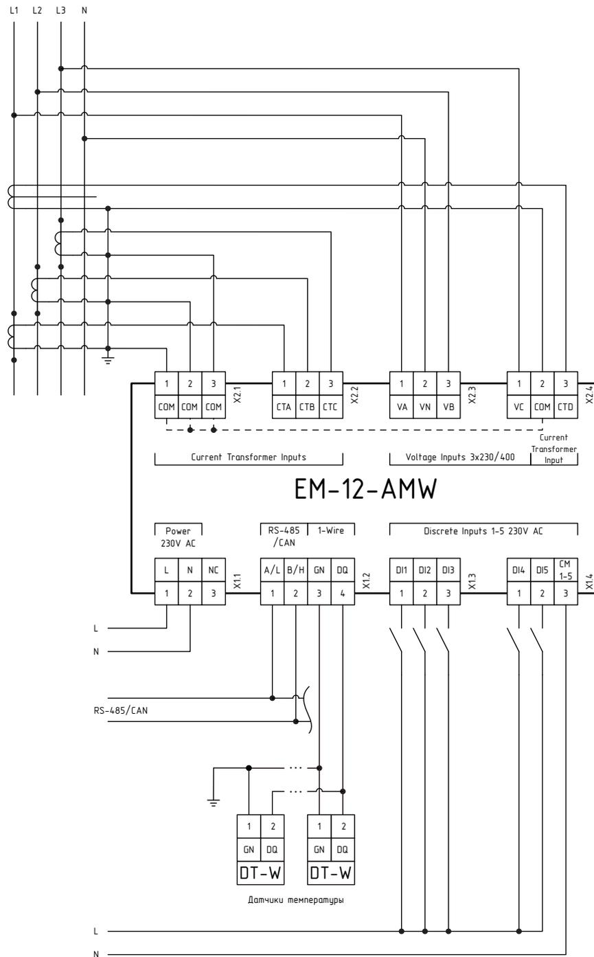
Рисунок А.13 – Трёхфазное четырёхпроводное соединение
