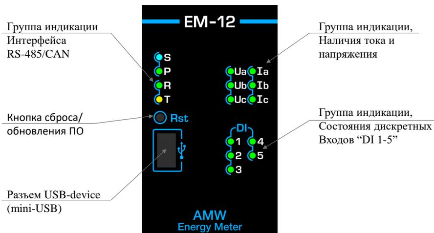
Рисунок 1.3 – Панель индикации
