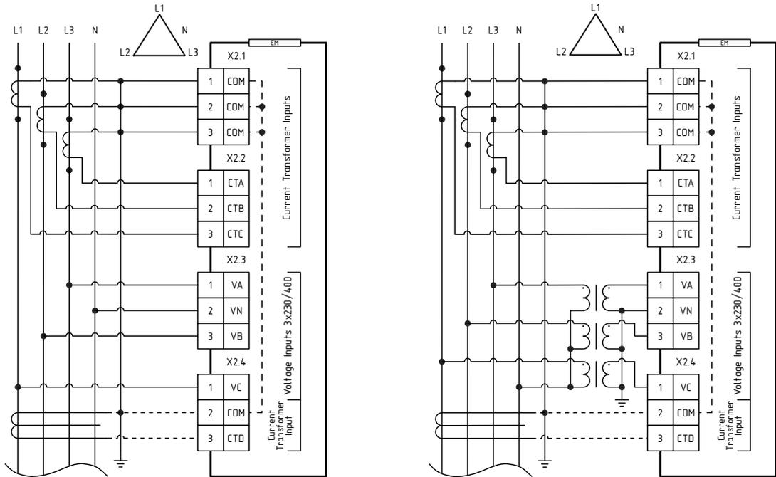
Рисунок А.1 – Трёхфазное четырехпроводное соединение 4LL3
