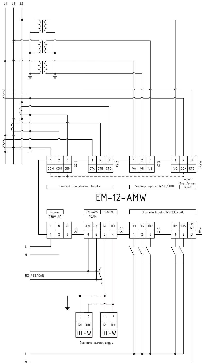
Рисунок А.12 – Трёхфазное трехпроводное соединение
