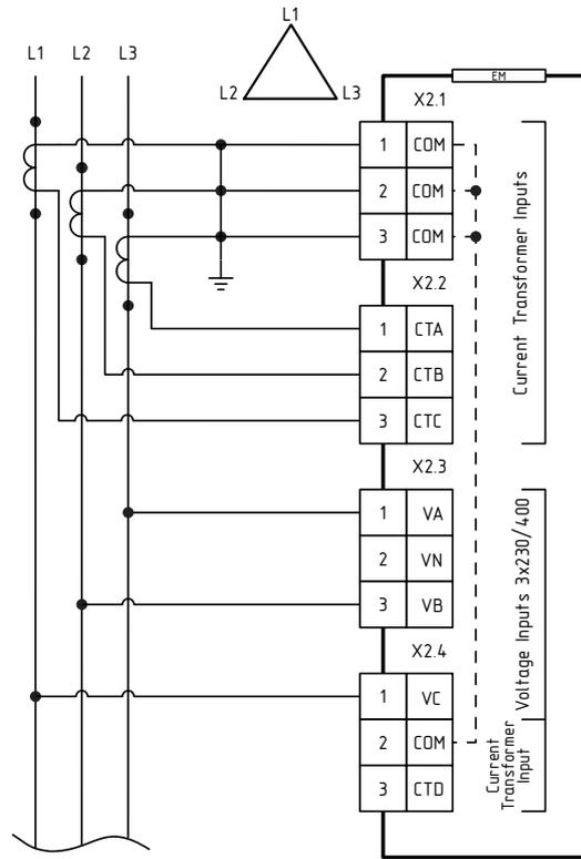
Рисунок А.6 – Трёхфазное трёхпроводное соединение 3L3, использующее 3 трансформатора тока
